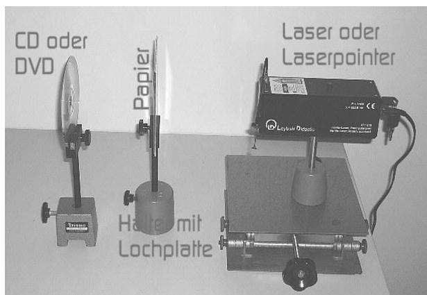
Laser oder Laserpointer, durchbohrte Platte und CD bzw. DVD werden wie im Bild des Versuchsaufbaues gezeigt, aufgestellt. Die der CD bzw. DVD zugewandte Seite der durchbohrten Platte wird mit einem festen Papier beklebt und dieses ebenfalls durchbohrt. Nun wird die CD bzw. DVD so lange gedreht, bis das Maximum 0. Ordnung (hellster Punkt) genau wieder in das Loch des Papiers fällt. Nun können die Abstände zum 1. Maximum mit dem Lineal gemessen werden. Um gute Messergebnisse
