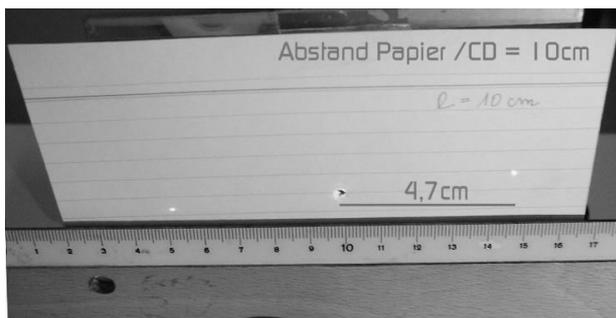
Nebenan ist ein Ergebnis des Versuches mit einer CD abgebildet. Der Abstand CD und Papier betrug 10cm der Abstand zwischen dem 0. Maximum und dem 1. Maximum beträgt 4,7cm. Die Laserwellenlänge beträgt 632nm.
